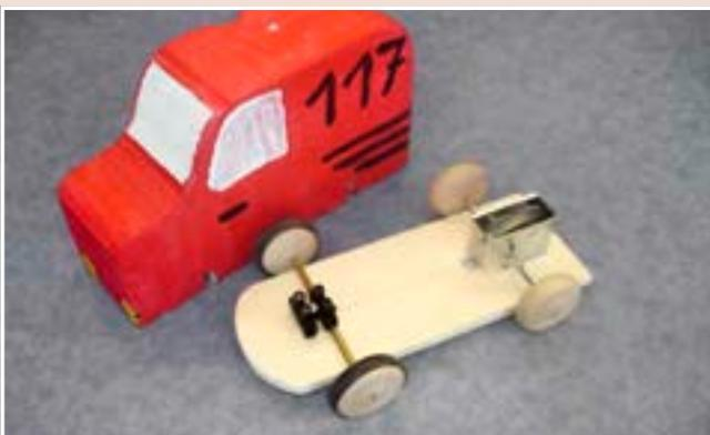
Prototyp eines Fahrzeugs mit Federwerktriebemotor
