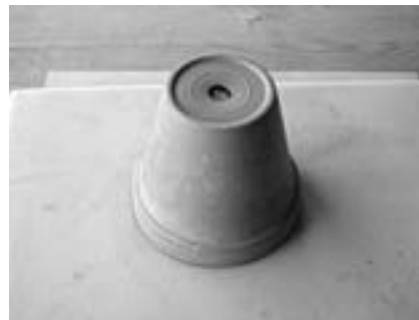
Sobald sich der eingeformte Topf von der Stützform löst (nach ca. 1 bis 2 Std.), kannst du ihn drehen und auf eine Schaumstoffunterlage stellen.
