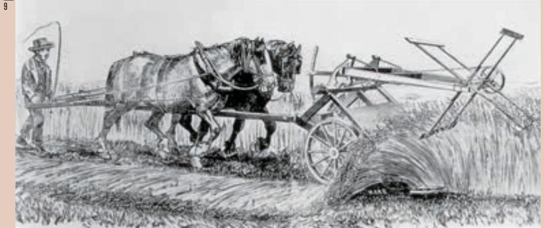
**Mähmaschine.** Die erste Maschine für das automatische Mähen von Getreide konstruierte der Schotte Bell um 1830. Aber erst ab 1850 fanden amerikanische Bauern Verwendung für derartige Maschinen.
